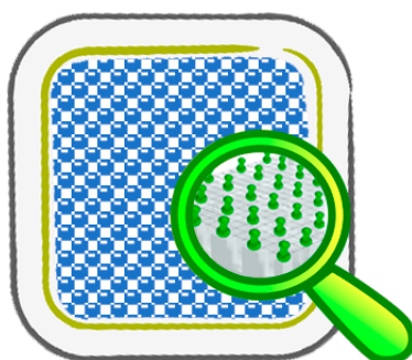
Figura 3.- Representación de uno de los parches vibro-táctiles con la vista en detalle de cómo se alinean dentro de él los actuadores.
